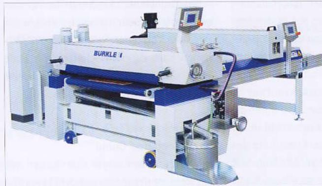
Der Large Format Coater ist sowohl für alle Digitaldrucke als auch feste Substrate bis zu einer Stärke von 80 Millimeter geeignet.
