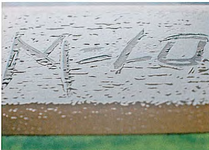
Kein Holz, sondern mehrere übereinandergedruckte Schichten Strukturlack
