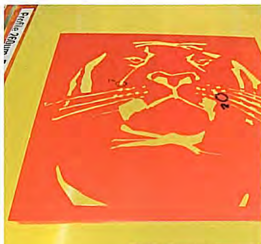
Dickschichtschablonen für den Druck von haptischen Effekten lassen sich entweder – wie hier zu sehen – mithilfe von Kopierschichten realisieren, die über einen sehr hohen Feststoffanteil verfügen, oder aber mit Kapillarfilmern.
