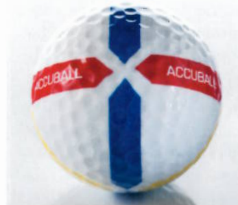
Sportlich, sportlich: Der Tampondruck kommt unter anderem bei der Bedruckung von Golfbällen und Skibindungen zum Einsatz.
