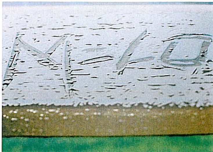
Kein Holz, sondern mehrere übereinandergedruckte Schichten Strukturlack
