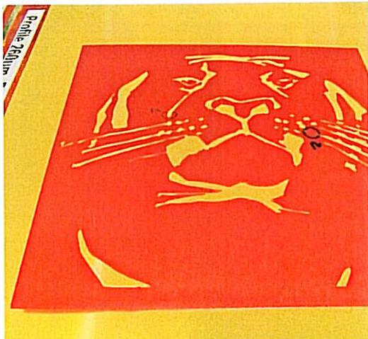
Dickschichtschablonen für den Druck von haptischen Effekten lassen sich entweder – wie hier zu sehen – mithilfe von Kopierschichten realisieren, die über einen sehr hohen Feststoffanteil verfügen, oder aber mit Kapillarfilmen.
