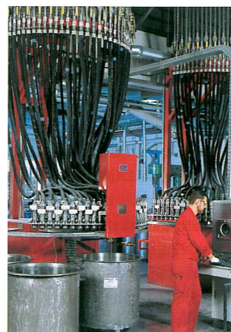
Dosierstation, an der die Bindemittel eingewogen werden.
